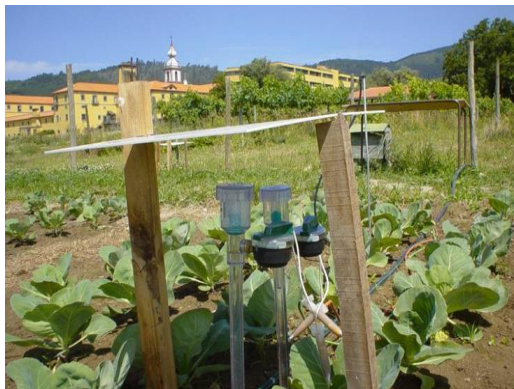
Figura 4.13 - Tensiómetros de vácuo eléctricos ligados ao sistema de rega por micro-aspersão. Fonte: Proj. Agro 747, ESA Ponte de Lima.
