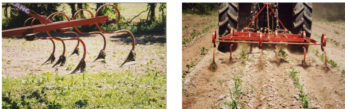
Figura 4.11 - Escarificador de bicos utilizado na sacha mecânica de culturas hortícolas em linha. Fonte: Rui Pinto, Marco de Canavezes.
